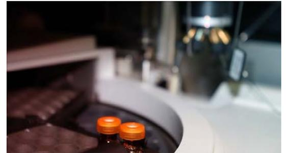
„Autosampler“ der HPLC-Anlage
