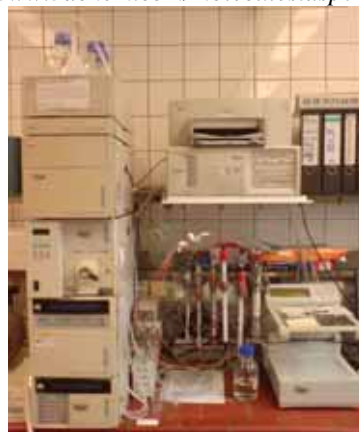
Hochleistungsflüssigkeitschromatographie (HPLC) Anlage
