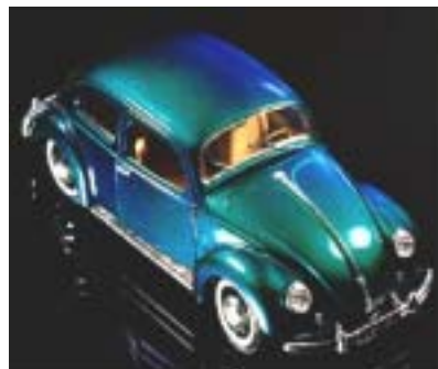
Natürlicher Käfer mit seiner natürlichen Farbe, verglichen mit einen künstlichen Käfer eingefärbt mit einer flüssigkristallinen Reflektivfarbe auf Basis nachwachsender Rohstoffe (Bild: BASF-AG)
