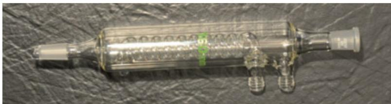
**Abbildung 13: Kühler mit Glasoliven für den Kühlwasseranschluss mit Adaptern, die Kunststoff-Schnellkupplungen nachrüsten**
