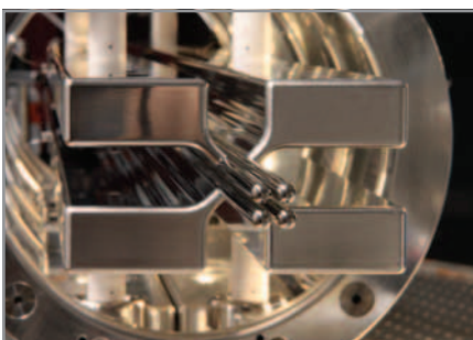
Elektrischer dynamischer Fokussierer zur Separation einzelner Quantenzustände großer Moleküle.
