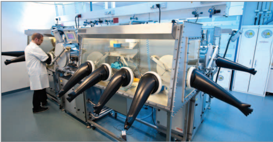
Abbildung 3: Anlage zur Herstellung von Solarzellen unter Schutzgasatmosphäre
