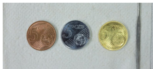
Veranschaulichung der Legierungsbildung zwischen Kupfer und Zink am Beispiel der "Versilberung" und "Vergoldung" einer 5-Cent-Münze.
