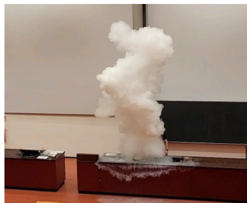
Eindrucksvolle Darstellung der Volumenzunahme beim Übergang vom flüssigen in den gasförmigen Aggregatzustand (flüssiger Stickstoff in warmes Wasser)
