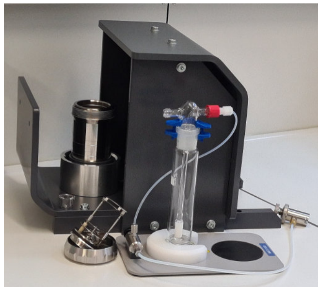
Hochdrucksauerstoffverbrennungsaufschlussgefäß mit Teilen der dazugehörigen Peripherie
