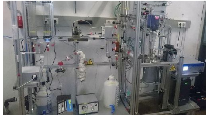
Eine Versuchsanlage für die Umsetzung von Biomasse zu Ameisensäure mit Hilfe von Sauerstoff im sogenannten OxFA-Prozess, Bildnachweis: privat
