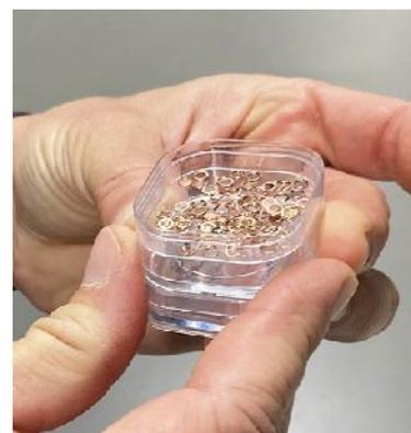
*Probenhalter für die Cryo-REM*
