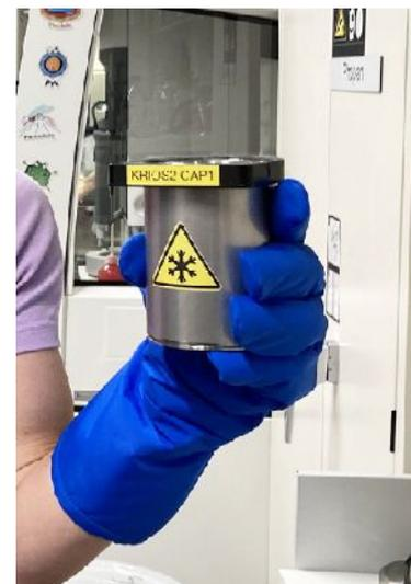
*Probentransfer-„Tasse“ mit flüssigem Stickstoff bereit für die Untersuchung.*
