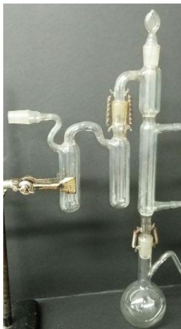
Destillationsapparatur (Kolben und Kühler G20, Kühlfalle Thermometerglas)
