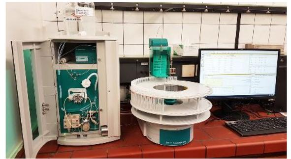
Der neue Ionenchromatograph mit Autosampler und Steuer-PC
