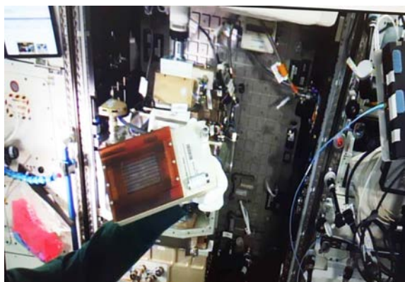
Flugkassette während der Installation am LMM-Mikroskop in der Internationalen Raum Station.
