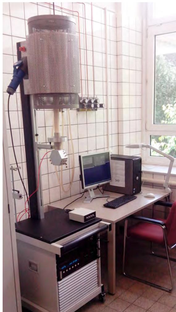
Seit Anfang Juni 2015 ist in den Laboren von Prof. Simone Mascotto im Institut für Anorganische und Angewandte Chemie ein Hochtemperaturaufbau der Firma Novocontrol für die Untersuchung der Festkörperelektrochemie nanostrukturierter Metalloxide vorhanden.
