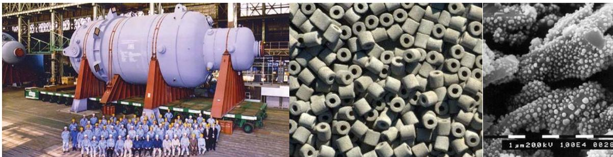
**Links:** Moderner Rohrbündelreaktor für die katalytische Selektivoxidation von Ethylen zu Ethylenoxid. **Mitte:** Katalysatorpellets im Inneren des Reaktors. **Rechts:** Primärpartikel des Ag/Al<sub>2</sub>O<sub>3</sub>-Katalysators im Elektronenmikroskop.
