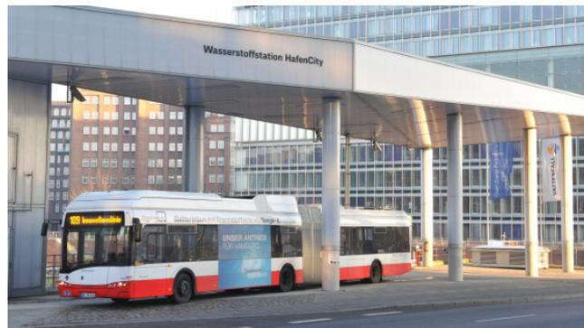
Batteriebus mit Brennstoffzelle als Range-Extender beim Tankprozess an der Wasserstoffstation HafenCity
