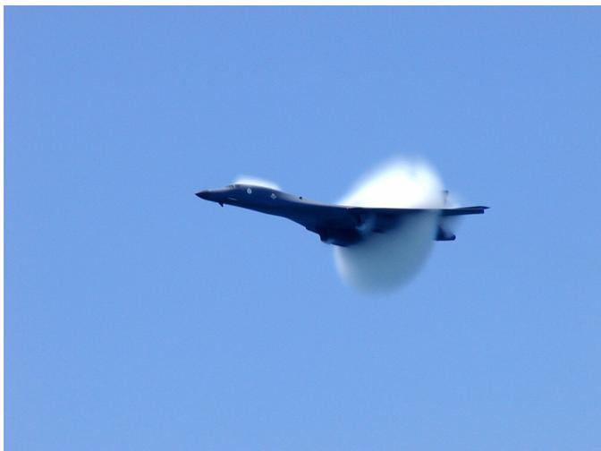
Eine Stoßwelle ist eine sich ausbreitende Schallwelle, in der größere Teile der Materie, meist der Luft, oder auch nur einzelne Atome in Schwingungen versetzt werden. Stoßwellen sind kurze druckstarke Schallimpulse, die sich durch einen schnellen Druckanstieg und durch ein breites Frequenzspektrum auszeichnen.
